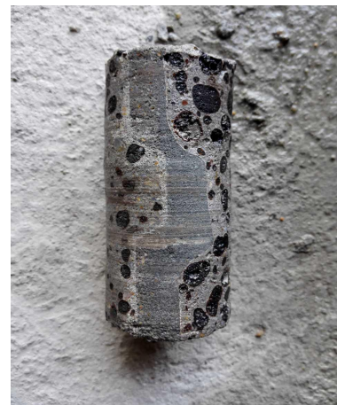
拼缝满浆满缝
